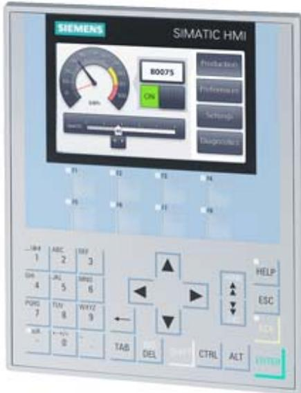
SIMATIC HMI KP400 Comfort, Comfort Panel, mando por teclado, pantalla TFT widescreen de 4", 16 millones de colores, Interfaz PROFINET, interfaz MPI/PROFIBUS DP, memoria de configuración de 4 MB, Windows CE 6.0, (soporte técnico de Microsoft ajustado incl. actualizaciones de seguridad) configurable a partir de WinCC Comfort V11
