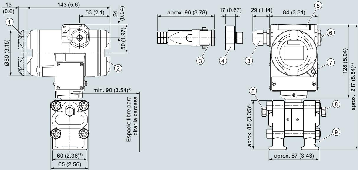
① Lado electrónica, indicador digital (mayor longitud en caso de tapa con visor)<sup>1)</sup>
