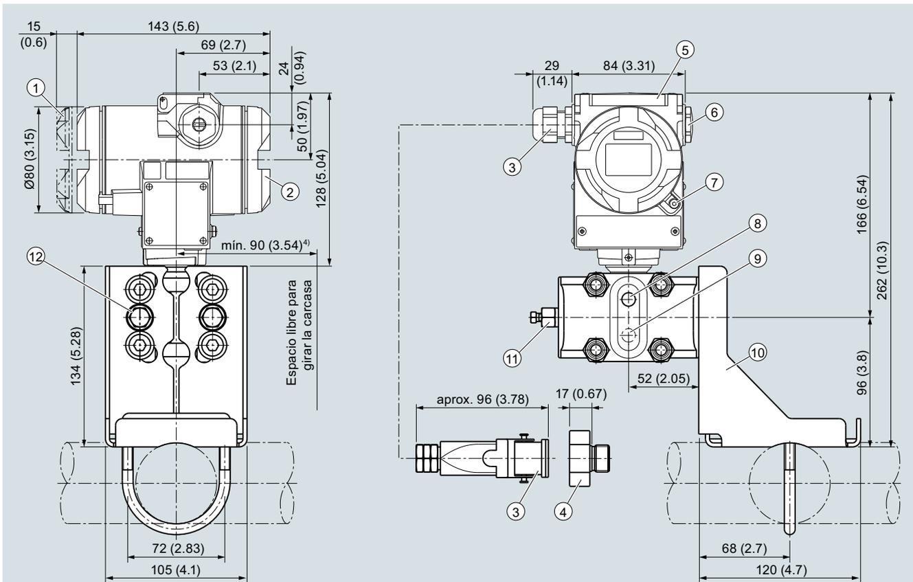
① Lado electrónica, indicador digital (mayor longitud en caso de tapa con visor)<sup>1)</sup>
