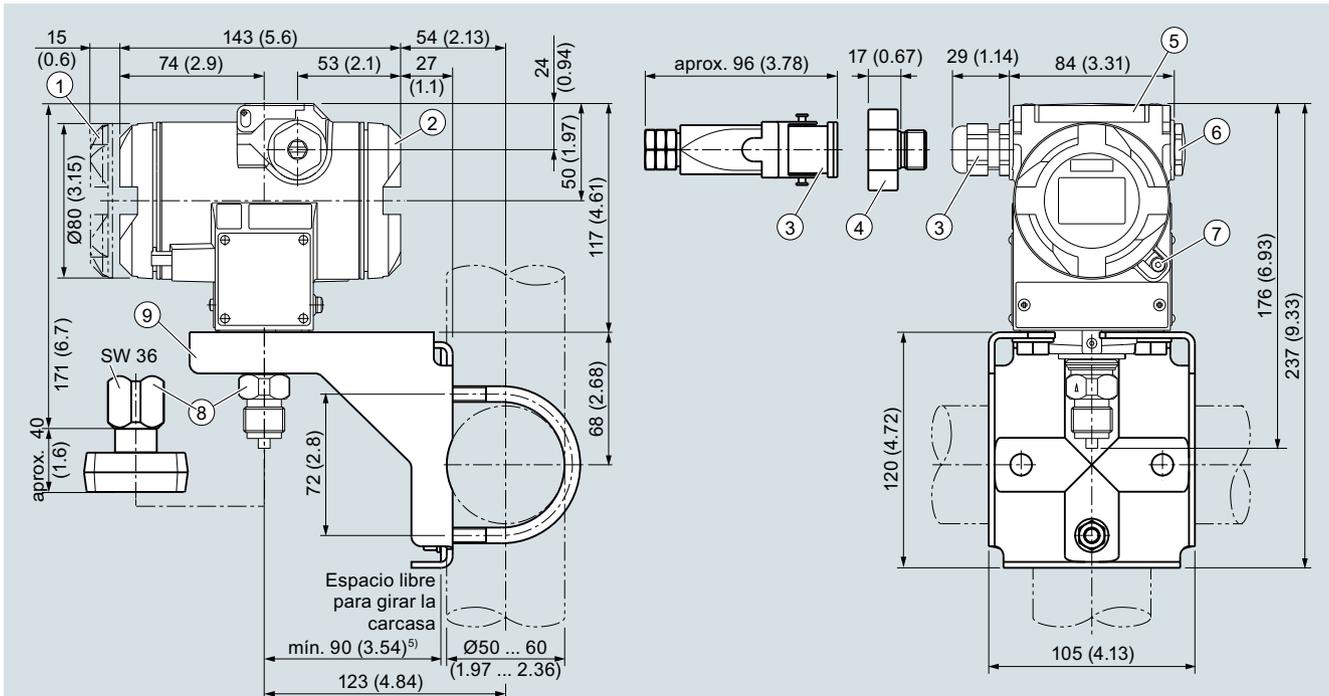
① Lado electrónica, indicador digital (mayor longitud en caso de tapa con visor)<sup>1)</sup>
