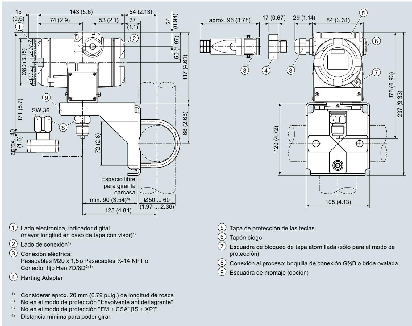
Transmisores SITRANS P DS III, para presión absoluta de la serie "Presión", dimensiones en mm (pulgadas)
