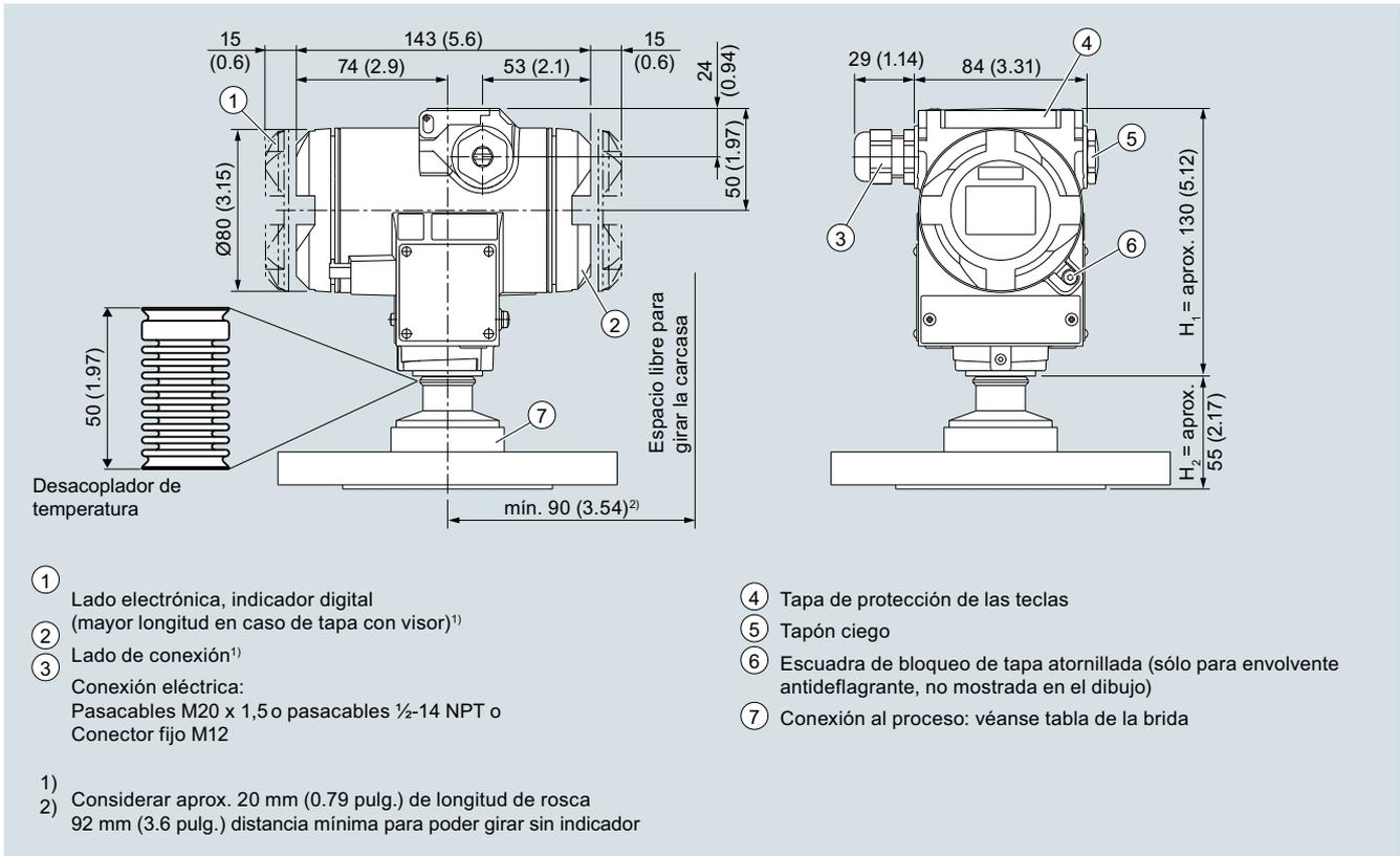
Transmisores de presión SITRANS P, serie DS III, para presión relativa, con membrana rasante, dimensiones en mm (pulgadas)
