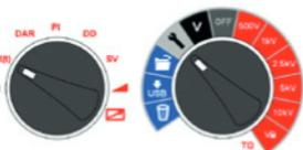
Una prueba de IR(t) temporizada terminará automáticamente una prueba de aislamiento después de un tiempo predeterminado. El temporizador predeterminado se establece en 1 minuto y puede ajustarse dentro de la función de configuración. Esta es una característica útil que le ahorra al usuario tener que mirar la pantalla durante toda la duración de la prueba y la posibilidad de pasar por alto la lectura de 1 minuto.
