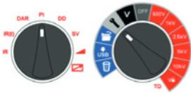
Las pruebas de DAR y PI son mediciones de resistencia a través del tiempo que se expresan como una proporción de la resistencia en el tiempo t2 dividida por la resistencia en el tiempo t1. El supuesto es que la temperatura de aislamiento no varía mucho durante la duración de la prueba, por lo que el valor resultante para DAR y/o PI es independiente de la temperatura. Las pruebas se deben realizar a una temperatura igual o inferior a 40 °C, 104 °F para mantener este supuesto.
