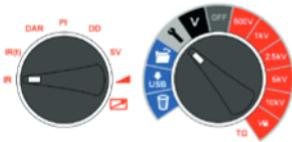
Para ajustar el voltaje de bloqueo VL definido por el usuario, gire el interruptor giratorio central a configuración y el interruptor de modo a IR. El voltaje predefinido de 5000 V parpadeará y se puede cambiar con los botones de arriba/abajo. Cuando aparezca el voltaje máximo requerido, presione el botón OK para guardar la configuración. Esta configuración se mantendrá hasta restablecerla.
