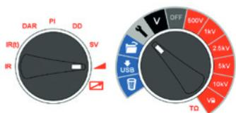
La prueba de voltaje de rampa es una prueba de sobrevoltaje similar a la prueba de SV, pero con un mejor control y alerta de falla potencial en el aislamiento. Es menos probable que la rampa de voltaje continuo lento resulte en daños imprevisibles en el aislamiento que los aumentos de paso rápido empleados en la prueba de SV.
